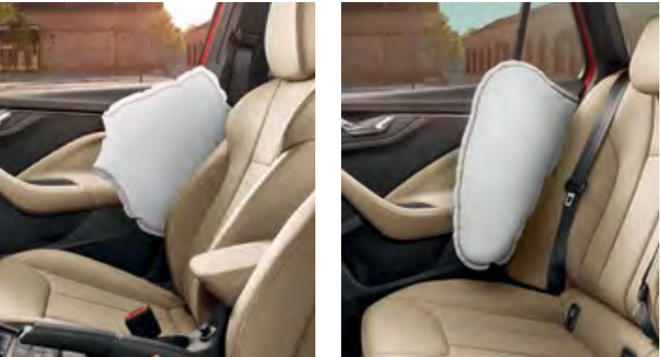
AIRBAG-URILE LATERALE DIN FAȚĂ ȘI DIN SPATE Acele airbag-uri protejează zona pelviană și pe cea toracică a șoferului și pasagerilor în cazul unei coliziuni laterale.
