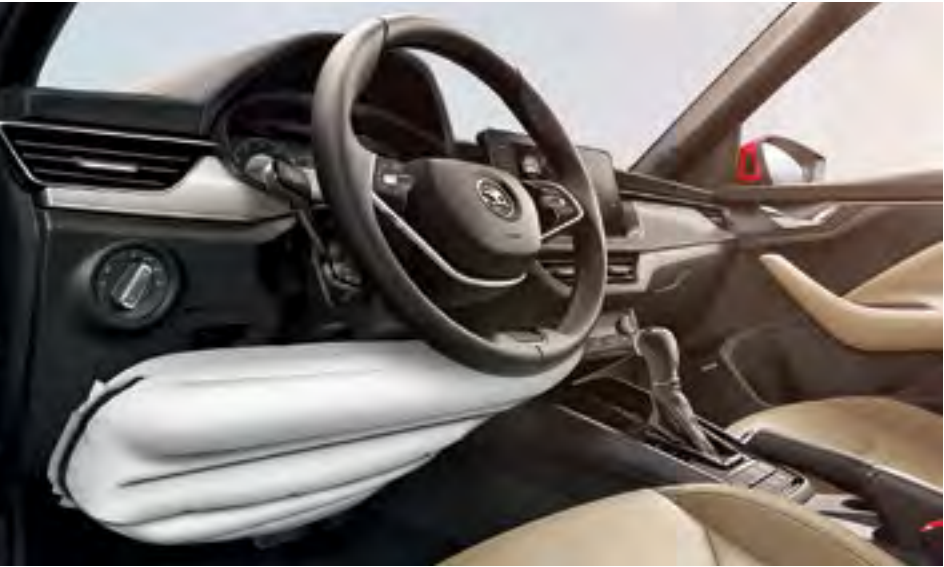
AIRBAG-UL PENTRU GENUNCHI Acest airbag, aflat sub coloana de direcție, protejează genunchii și tibiaile șoferului.
