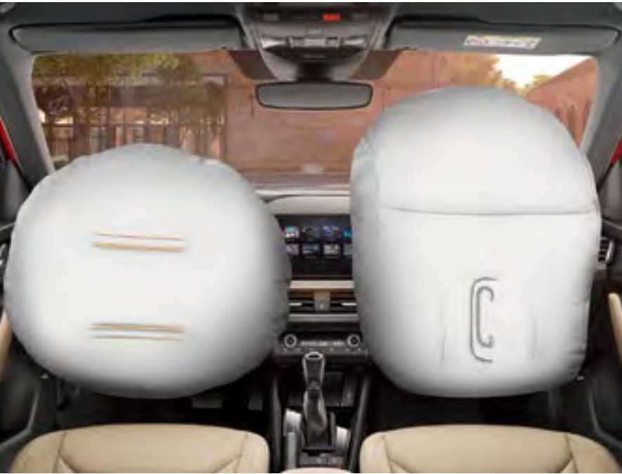
AIRBAG-URILE FRONTALE Airbag-ul șoferului este integrat în volan, iar cel al pasagerului din față este integrat în bord. Dacă este nevoie, airbag-ul pasagerului din față poate fi dezactivat pentru montarea unui scaun pentru copii pe locul din dreapta față.
