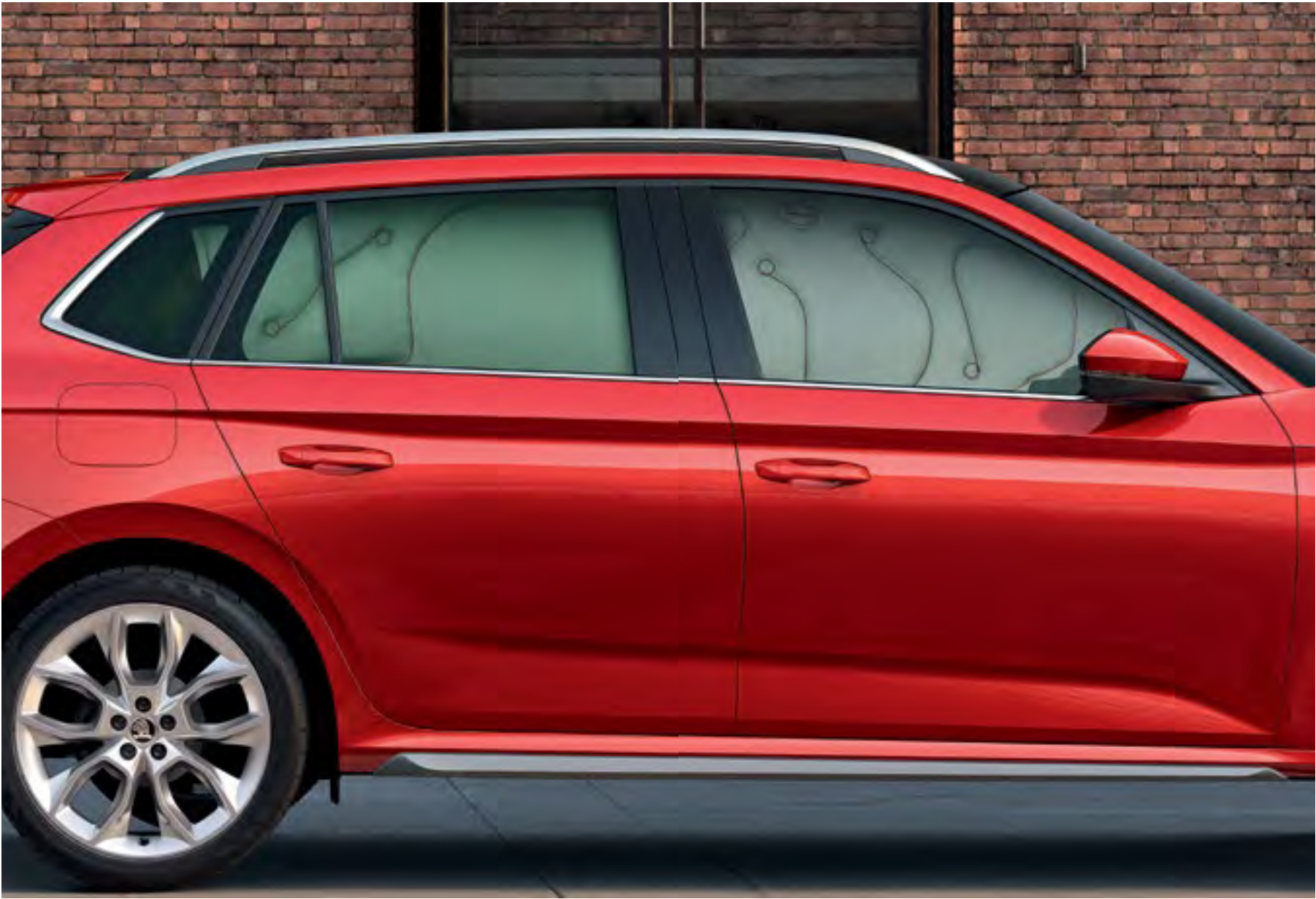
AIRBAG-URILE PENTRU CAP La activare, airbag-urile pentru cap creează un perete care protejează ocupanții din față și din spate de rănirea la nivelul capului.
